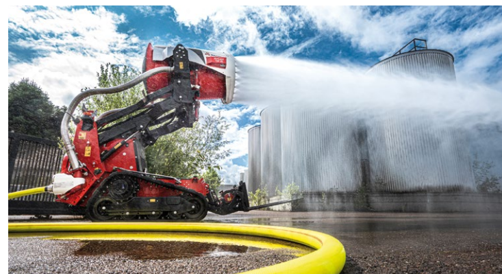
Volle Power: Mit 4700 Liter pro Minute wirft die Turbine einen Wassernebel
