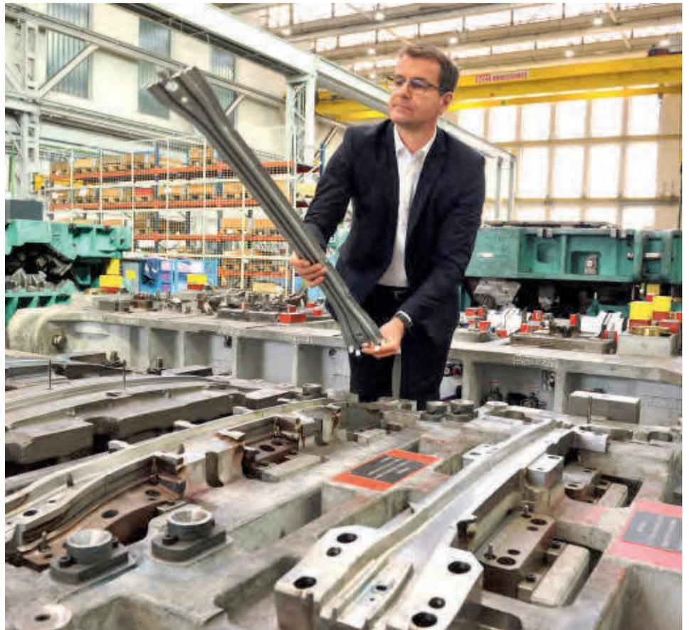
die B-Säulen eines Autos quer verbindet, üblicherweise mittels Warmumformung bei 800 bis 1000 Grad in Form gezogen und anschließend gehärtet. Mit Variotempo geschieht diese Umformung bei Umgebungstemperatur, wodurch die Energiekosten im Herstellungsprozess enorm gesenkt werden und doch eine Festigkeiten von bis zum 1200 MPa (Megapascal) erreicht wird. Darüber hinaus kann die Materialdicke reduziert werden,
